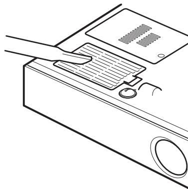
Si resulta difícil retirar el polvo del filtro con un aspirador, desmonte el filtro de aire y lávelo.
