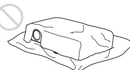
Evite emplear algo que cubra los orificios de ventilación (escape/aspiración); en caso contrario, es posible que se produzca un recalentamiento interno.
