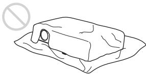
Ne recouvrez pas les orifices de ventilation du projecteur (prise/sortie d'air) pour éviter une surchauffe interne.
