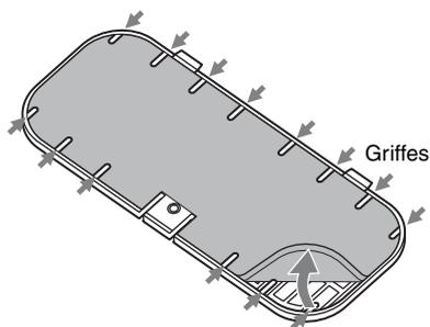
**5** Lavez le filtre à air au moyen d'une solution détergente neutre et faites-le sécher dans un endroit à l'ombre.
