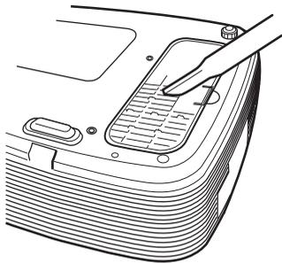
当难以用真空吸尘器清除滤网上的灰尘时，请拆下空气滤网进行清洗。
