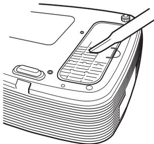
Si resulta difícil retirar el polvo del filtro con un aspirador, desmonte el filtro de aire y lávelo.
