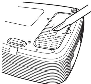
Quando diventa difficile togliere la polvere dal filtro usando l'aspirapolvere, smontare il filtro dell'aria e lavarlo.
