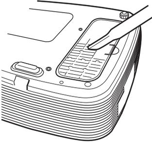
Wenn das Reinigen des Filters mit einem Staubsauger schwierig wird, bauen Sie den Filter aus und waschen Sie ihn.
